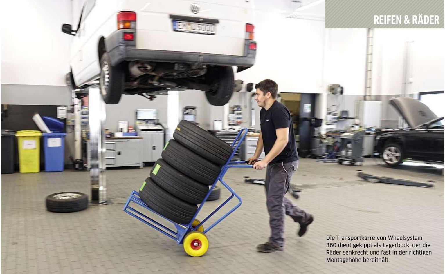
Die Transportkarre von Wheelsystem 360 dient gekippt als Lagerbock, der die Räder senkrecht und fast in der richtigen Montagehöhe bereithält.
